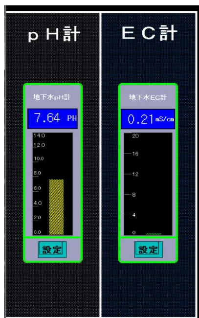
図 9: 中央タッチパネル (地下水ピットpH・EC)
